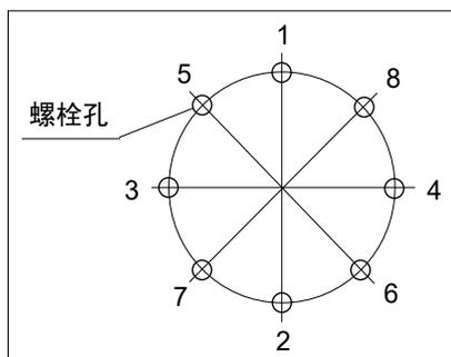
固定时，请勿一次性紧固螺栓，而要用六角扳手分2、3圈紧固，然后使用扭矩扳手等按上表所示的紧固扭矩值进行紧固。然后使用扭矩扳手按上表所示的紧固扭矩值进行紧固。
