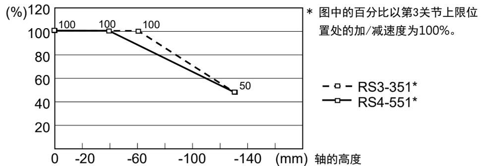
NOTE 如果在轴下降后的状态下进行水平移动，定位时则可能会产生过冲。
