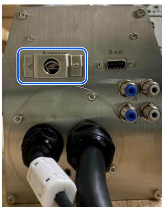
4. Schließen Sie die Bremslöseeinheit am Stecker des Anschlusskabels an.
