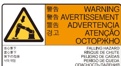
Achten Sie beim Lösen der Bremsen darauf, dass der Arm nicht durch sein eigenes Gewicht herunterfällt.
