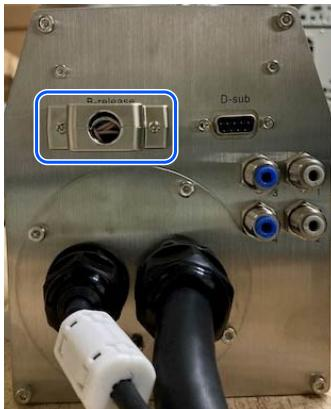
3. Schließen Sie die Bremslöseeinheit am Stecker des Anschlusskabels an.
