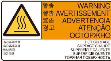
Die Oberfläche des Manipulators ist während und nach dem Betrieb heiß und es besteht die Gefahr von Verbrennungen.
