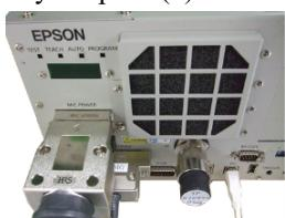
3. Retire el conector de cortocircuito externo.
