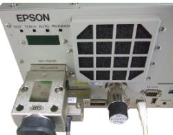
3. Retire el conector de cortocircuito externo.
