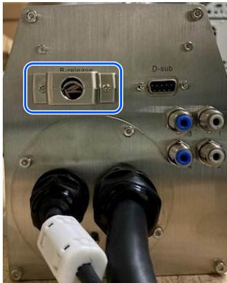
3. Conecte la unidad de activación del freno al conector del cable de conexión.
