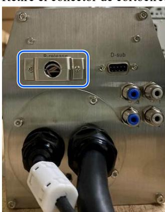
4. Conecte la unidad de activación del freno al conector del cable de conexión.
