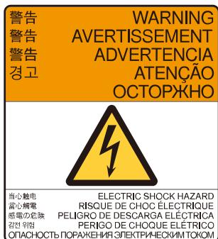
Tocar cualquier parte electrificada interna mientras la alimentación esté encendida podría causar una descarga eléctrica. Además, en relación con las especificaciones de sala limpia y ESD, si los cables del interior del manipulador se desgastan durante un largo periodo de funcionamiento y provocan un cortocircuito interno, el tubo de conducto puede electrificarse. Tocar el tubo de conducto mientras la alimentación esté encendida podría causar una descarga eléctrica.
