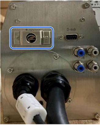
4. Branchez l'unité d'ouverture des freins au connecteur du câble de connexion.
