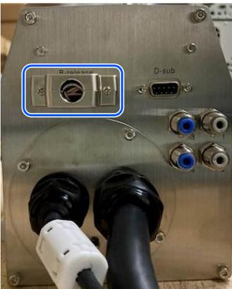
4. Branchez l'unité d'ouverture des freins au connecteur du câble de connexion.
