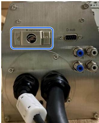
3. 接続ケーブルのコネクターにブレーキ解除ユニットを接続します。
