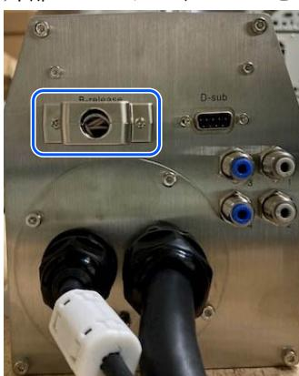
4. 接続ケーブルのコネクターにブレーキ解除ユニットを接続します。
