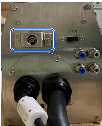
4. 接続ケーブルのコネクターにブレーキ解除ユニットを接続します。
