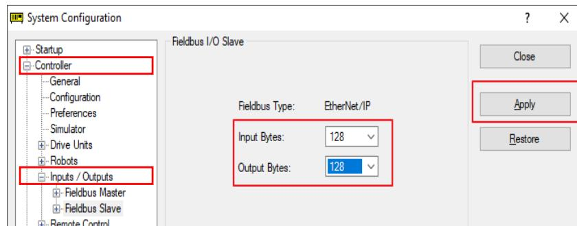
5. ツリーで[Fieldbus Slave]を展開し、[Ethernet/IP]を選択します。
