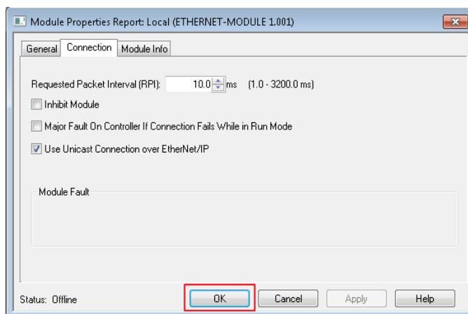
この段階でプロジェクトを保存しておくことをお勧めします。Ethernetモジュールを新規作成する場合は、接続パラメーターの値が使用しているロボットコントローラーの値と一致するようにしてください。
