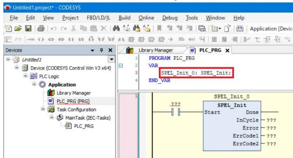
3-8. Start に接続されている a 接点の[???]をクリックします。
