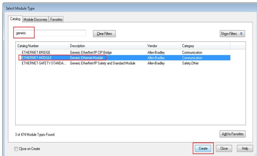
3. 以下のとおり値を入力し、ロボットコントローラーの EtherNet/IP スレーブの IP アドレスを使用して、<OK>をクリックします。
