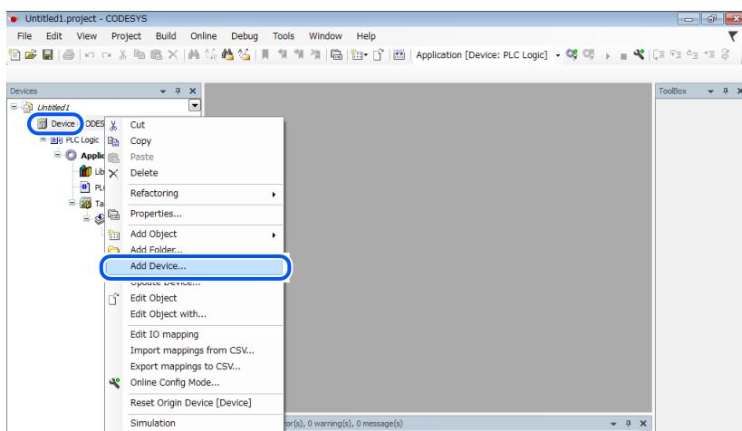
ii. [EtherCAT Master]を選択して、[Add Device]をクリックします。
