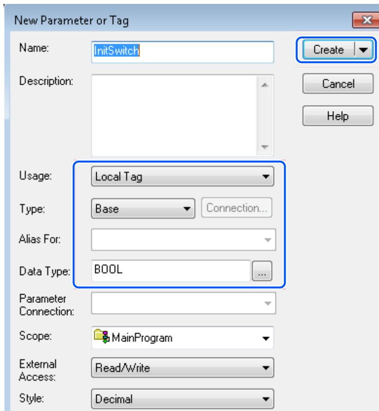
7. 上記と同じ手順を実行し、rung0で"Output Energize"の[?]をダブルクリックして、"InitCoil"と入力します。
