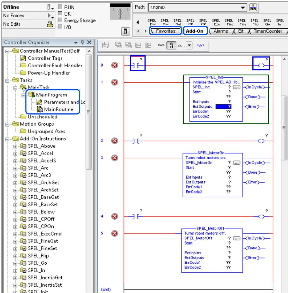
6. rung0で、"Examine On"の[?]をダブルクリックし、変数名を入力します。ここでは"InitSwitch"と入力します。
