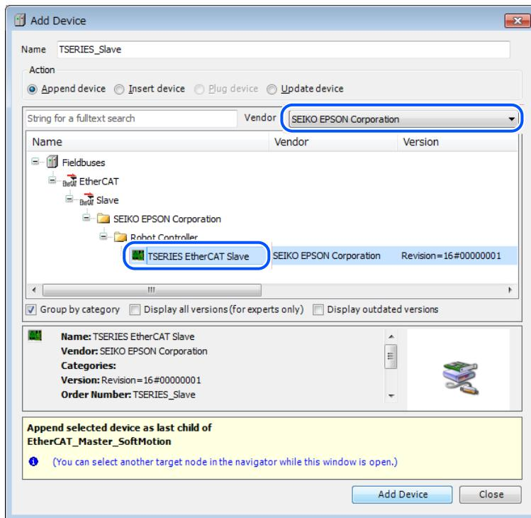
ix. [TSERIES\_Slave]をダブルクリックし、[Process Data]をクリックします。
