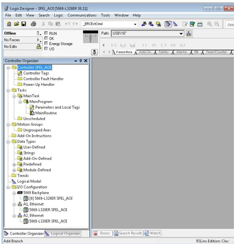
5. 次に、ロボットコントローラーとの通信用のEthernetモジュールを追加して設定する必要があります。これを行うには、EpsonEtherNetIP.L5Xファイルをインポートする方法と手動で設定を行う方法の2通りの方法があります。
