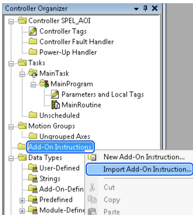
2. ¥EpsonRC80¥Fieldbus¥FunctionBlockLibraries¥Allen-Bradley に移動し、"SPEL\_All.L5X" ファイルを選択して、[Open]をクリックします。
