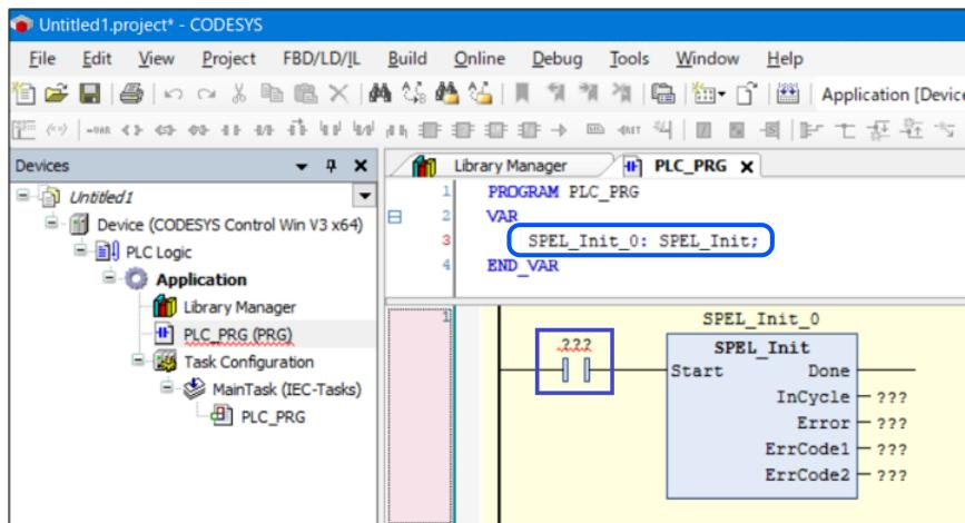
viii. Startに接続されているa接点(上図青枠部)の[??]をクリックします。
