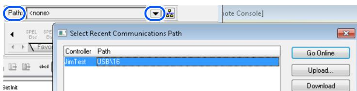
この例では、USBを使ってPCをPLCコントローラーに接続しています。
