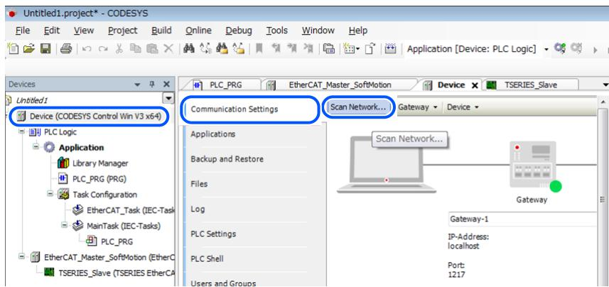
iii. 表示されているデバイスを選択し、[OK]をクリックします。
