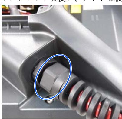
6. トルクレンチを使い、筐体穴からケーブル固定部品を緩めて取りはずします。
