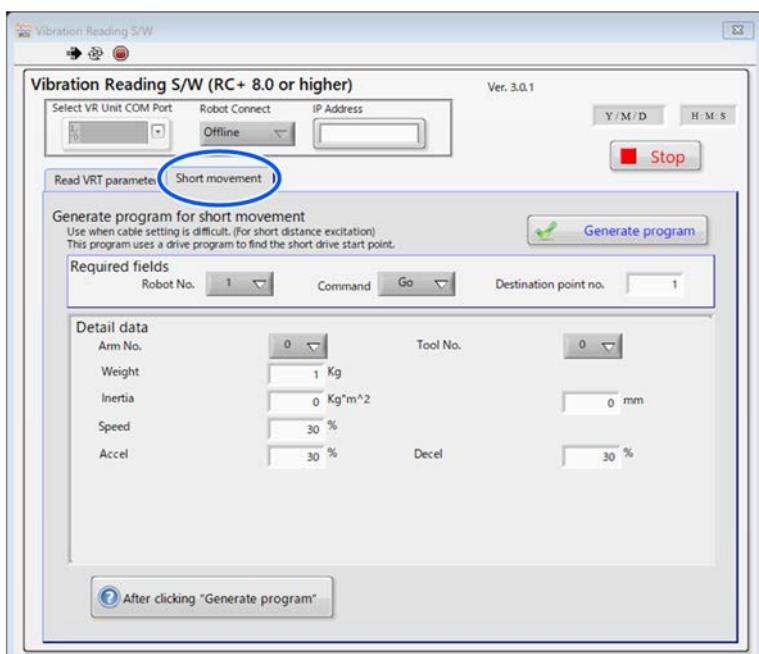
4. 振動発生動作の到達点のポイント番号や動作コマンド、速度や加速度などを、[Require fields] と [Detail data] の全ての項目に入力します。
