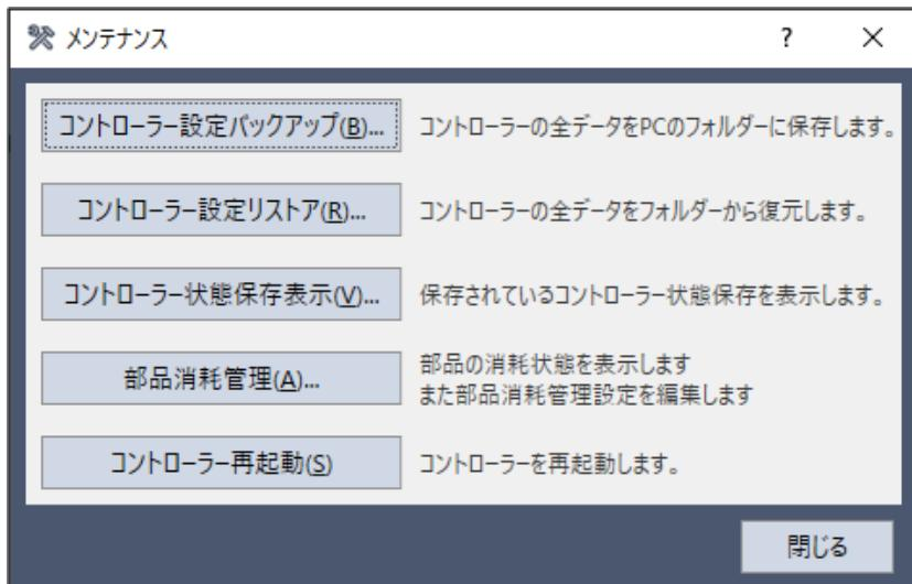
2. [コントローラー状態保存表示]ボタンをクリックし、[フォルダーの参照]ダイアログを表示します。
