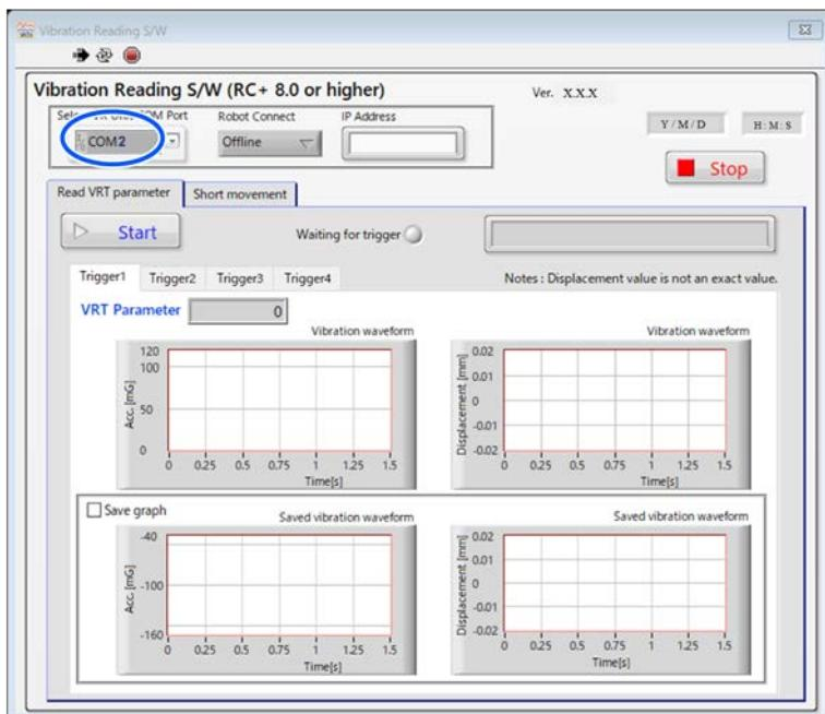
3. 起動中のEpson RC+とロボットの接続方法を指定します。
