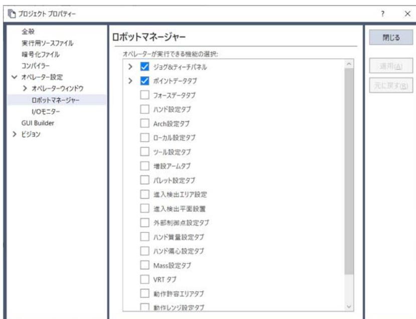
2. [オペレーターに実行を許可する機能の選択] - [VRT タブ] チェックボックスをチェックします。
