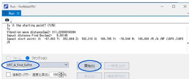
必ず、開始点に移動してから、[開始]ボタンをクリックしてください。
