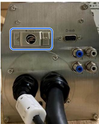
3. Conecte a unidade de libertação do travão ao conector do cabo de ligação.
