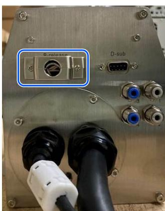
4. Conecte a unidade de libertação do travão ao conector do cabo de ligação.
