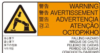
解除制动器时，请注意因机械臂自重而产生的下降和旋转。
