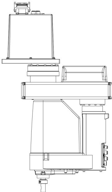
2. 请使用6个螺栓将底座固定在台面上。
