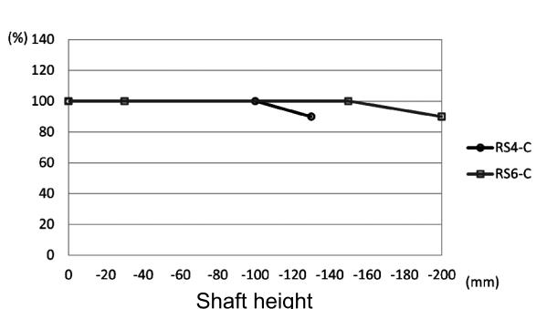
图中的百分比是当设置为额定值时，将轴上限位置的加减速速度设置为100%时的比率。
