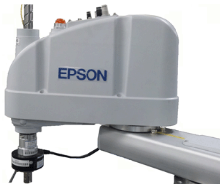
安裝伽瑪力覺感測器的 SCARA 機器人
