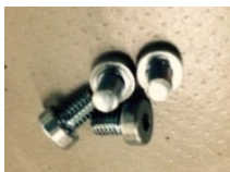
8. 機器人固定螺栓 內六角低圓柱頭螺栓: M4×6
