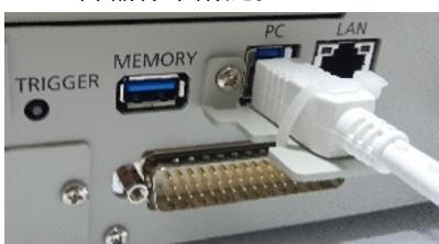
4. 將束線帶穿過步驟2中的固定支架的槽，固定USB傳輸線。
