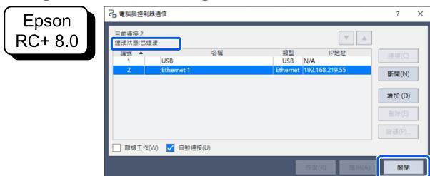
開發用PC與控制器的連接至此結束。現在可透過Epson RC+，以Ethernet連接使用機器人系統。
