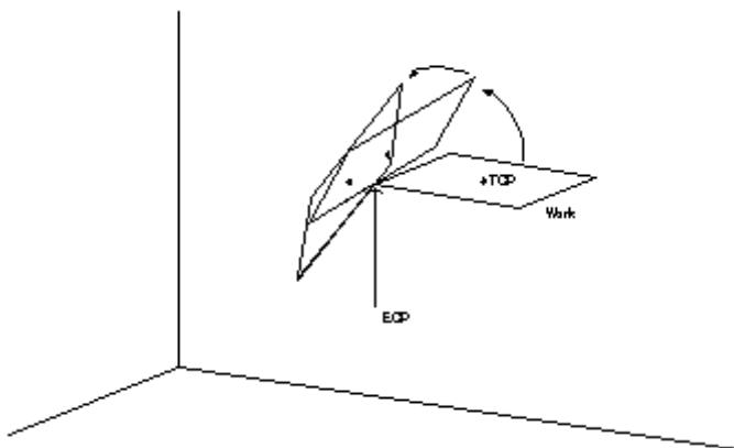
Move 動作完成之前，想使機械手減速停止時，可以指定 Till 選項。檢查輸入的狀態是 ON 還是 OFF，並根據指定的條件停止機械臂動作。該功能類似於輸入條件成立時停止 Move 的中斷。如果 Move 動作期間輸入條件從未成立，機械臂則到達由目標座標指定的位置。
