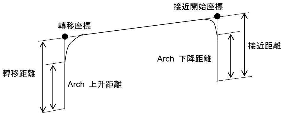
Jump3CP 的速度和加減速度分別使用 SpeedS 和 AccelS 的設定值。有關速度與加減速度之間的關係，請參閱注意中的「同時使用 Jump3、Jump3CP 和 CP」不過，指定 ROT 修飾參數時的速度和加減速度分別使用 SpeedR 和 AccelR 的設定值。此時，SpeedS 和 AccelS 的設定值變為無效狀態。
