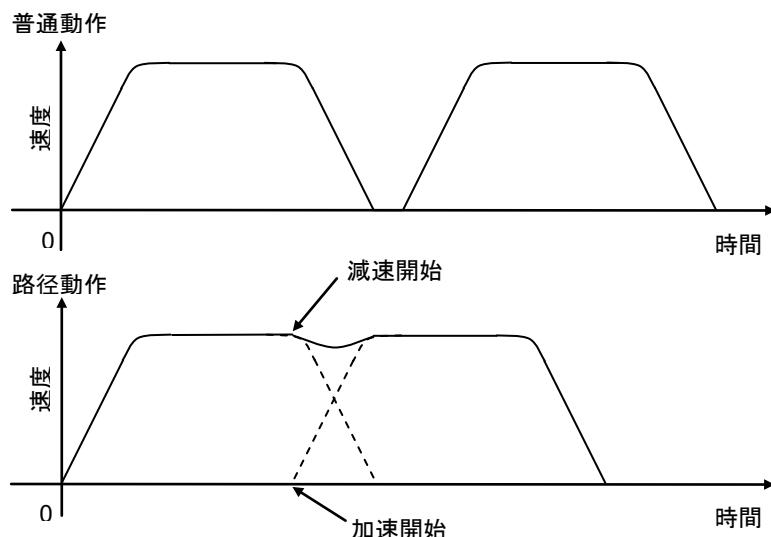
CP 動作 (Arc、Arc3、Jump3、Jump3CP、Move) 或者 PTP 動作 (Go、Jump) 將透過 CP On 合成動作軌跡。如果 CP 動作與 PTP 動作是連續軌跡，則只減速而不合成動作軌跡。
